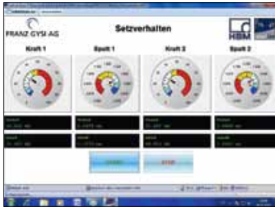
Elektronische Messung des Setzverhaltens einer Dichtung
