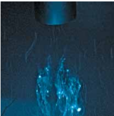
Demonstration von thermischen Schlägen und Kavitation
