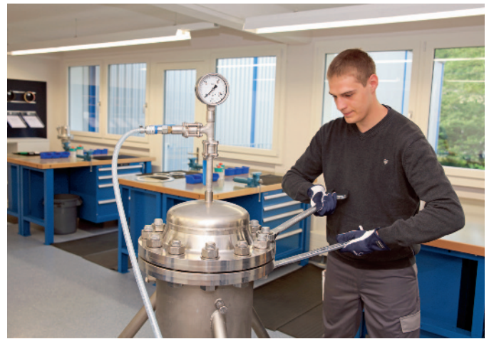
Grosser Wert wird unter anderem der Drehmoment-Kontrolle beigemessen, durch die vorhandene Messtechnik kann der Kursteilnehmer die Anzugsdrehmomente überprüfen.
